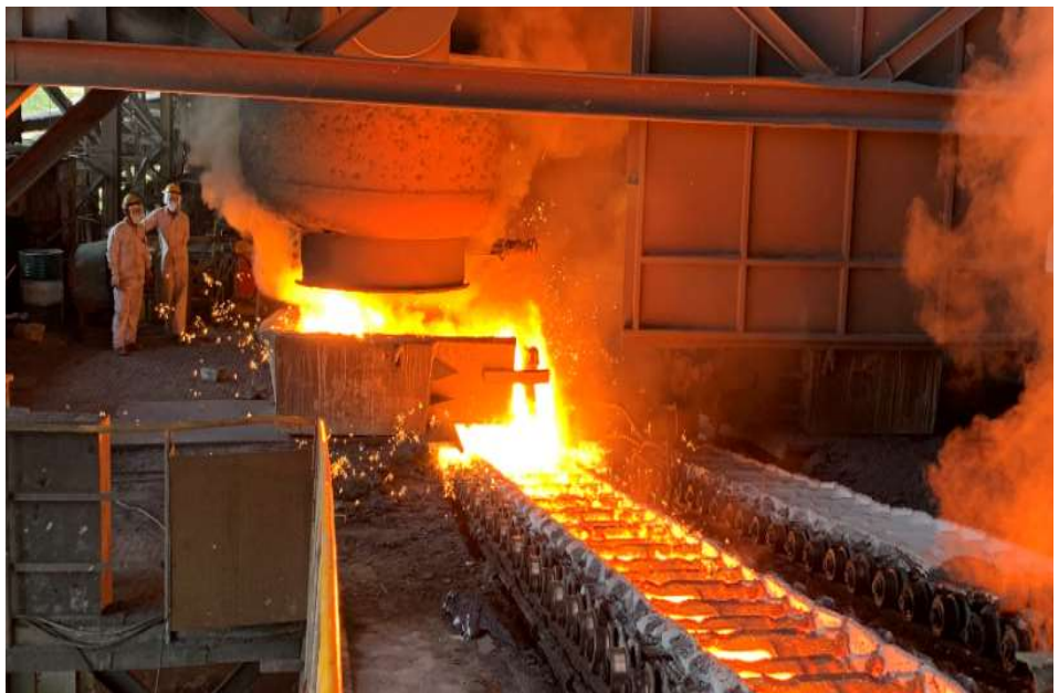
Ingot casting of NPI.
